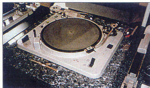
Une table de lecture EMT 930st, celle de R. Bassi. Bras EMT 929, cellule TSD 15. Sous la platine prennent place deux préamplis à tubes réputés, les EMT 139A.
